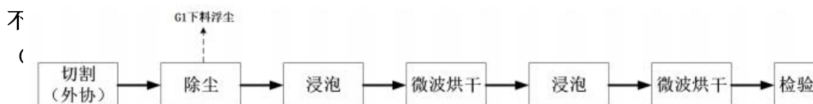
图 2-2 不燃无机纤维板生产工艺及产污流程图
